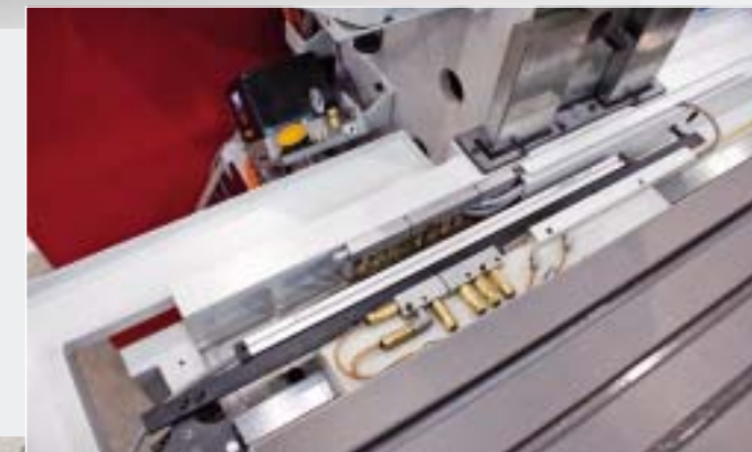
Die Kunzmann WF-Baureihe ist mit einem Fagor-Wegmesssystem der Serie MOP ausgestattet
