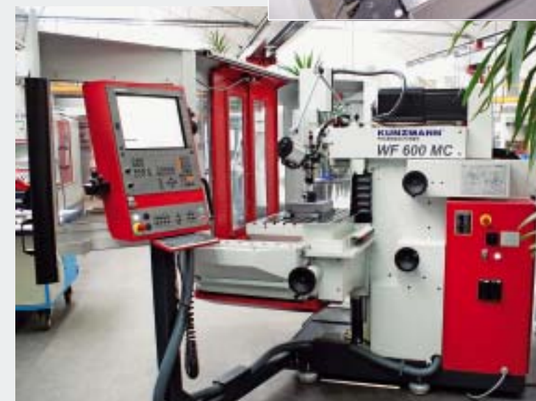
Die Verkleidung der WF-Maschinen lässt sich komplett aufklappen. Der Arbeitsraum ist dadurch besonders gut zugänglich
